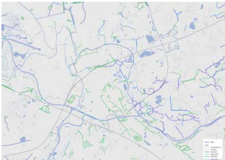
Figuur 13: Regenwaterafvoer. Naast het standaard rioleringsnet, zijn er ondergrondse regenafvoeren geconstrueerd. Deze hebben de functie om overtollig water, die het bovengrondse watersysteem niet kan verwerken, zo snel mogelijk naar grotere waterlopen af te voeren via regenwateruitlaten. Ze zijn vaak gesitueerd in overstromingsgevoelige gebieden.
